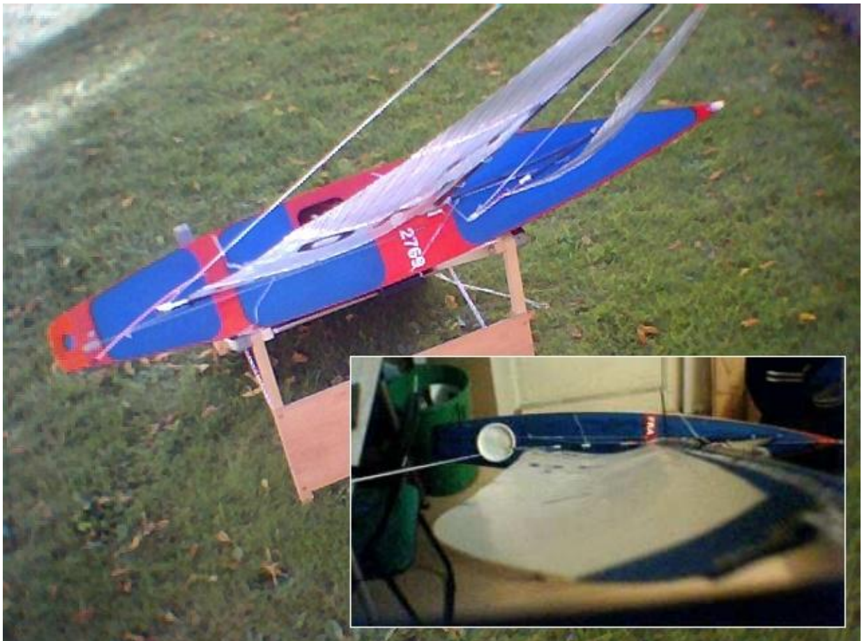
Photo 3 : Vue de dessus. Cette position permet de vérifier rapidement le bon réglage des voiles, la tête de mât venant à hauteur des yeux.
