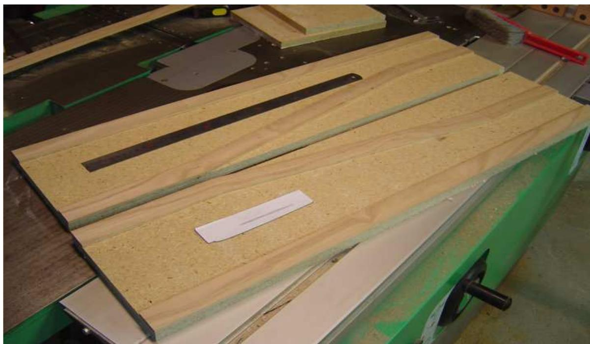
Il faut maintenant réaliser le gabarit, qui est la moitié du profil choisi. Un talon sera laissé sur le BA, et le BF sera prolongé de 20mm. J'imprime donc ce profil, le colle sur une plaque epoxy de CI (CI: circuit imprimé: époxy 16/10, je n'ai pas trouvé mieux en 20 ans), et le taille le plus précisément possible.
