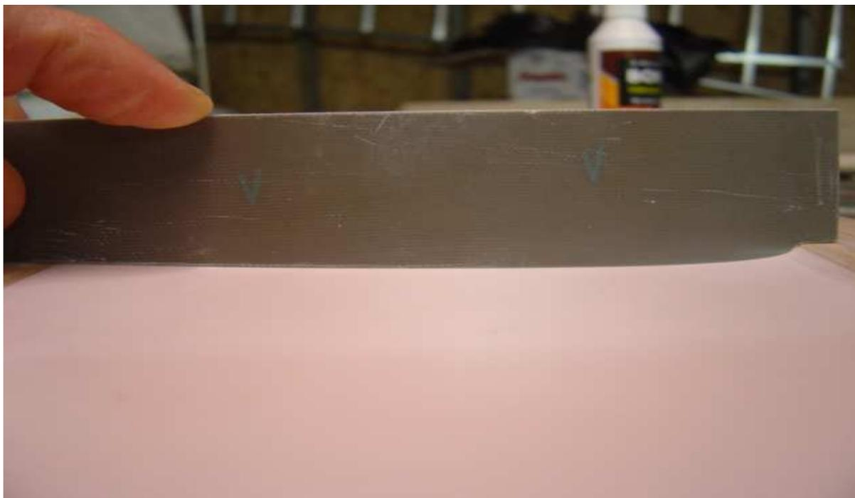
le résultat arrive vite, finition au 1000, puis cirage avec de la cire liquide qui va saturer les pores de l'enduit. 5 couches min car le mastic est poreux .
