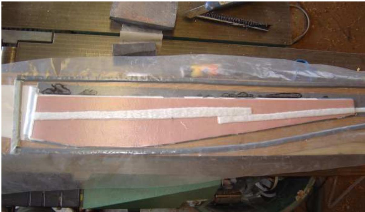
Un repli du tissu sur le BA lors de la strat forme un bourelet, qui une fois arrasé forme une bonne surface de collage de 3mm de large, sur le BF il n'y a pas de pb de collage vue la surface. J'en demoule une et la colle sous vide sur l'autre.
