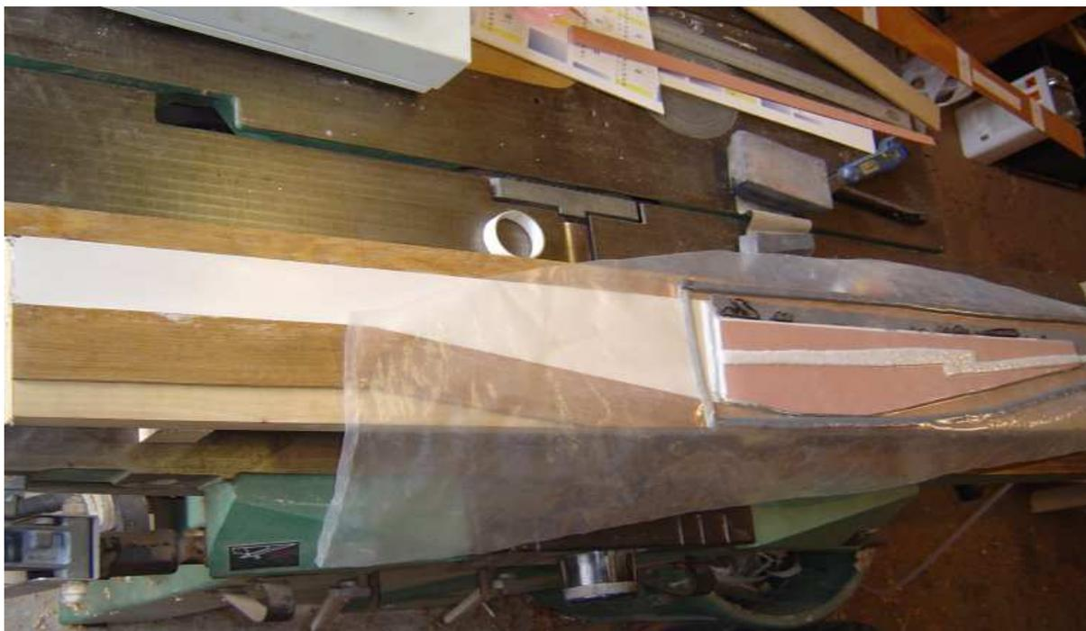
Le vide permet de passer d'un taux de résine/fibre de 100% à 30%, soit donc plus de fibre, donc de résistance, ou alors un gain de poids. Mais tout le monde peut le faire, avec un vieux groupe frigo pour la pompe, un vieux rideau nylon pour le déla et une vieille couverture pour le drainage, le micro-perforé c'est l'emballage des baguettes en supermarché, bon c'est vrais c'est dégueulasse, mais c'est pas grave, jeté la baguette et gardez l'emballage, c'est pile la taille pour une dérive.
