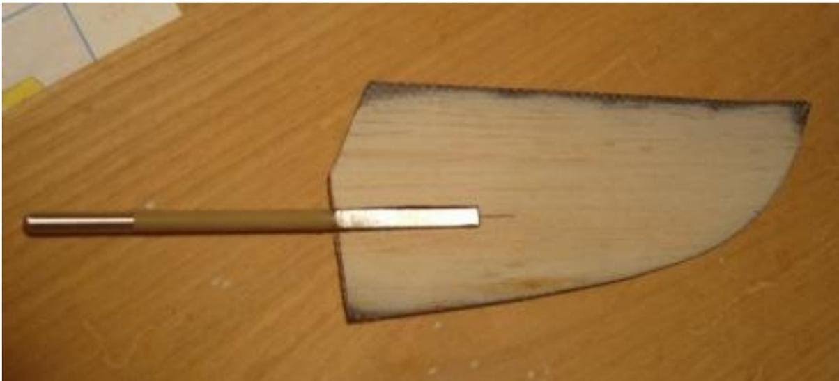
**Photo 1** : La forme prête à la stratification. Ici, mon axe fait 5mm en titane.
